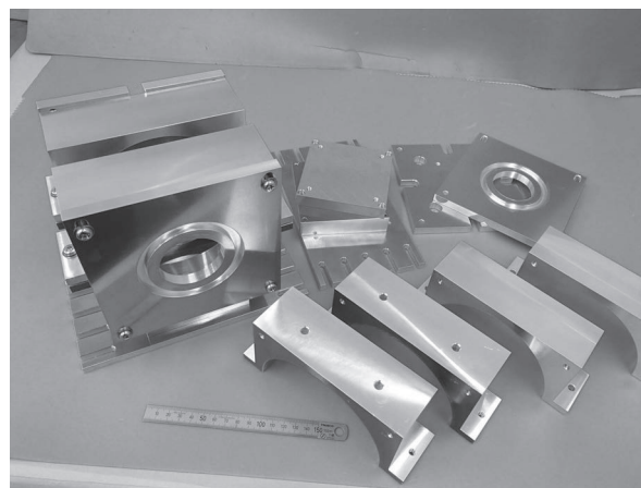
図 2 工作部の主な作製品（左：ピークアレイチャンバー、右：二次元検出器マウント 2 組）
