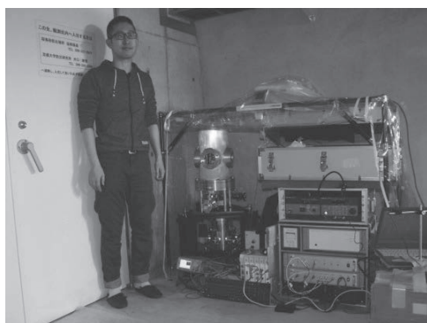
図5 微小距離投げ上げ装置を組み込んだ TAG-1 による観測（桜島・有村観測坑局舎）
