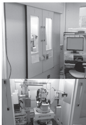
図 3 評価部保有の分析装置（左：X 線回折装置、右：電子ビーム蛍光 X 線元素分析装置）
