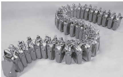
地面の凹凸を活用して推進可能なヘビ型ロボット。
