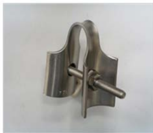
図 2-2 リバース U ベンド試験片外観
