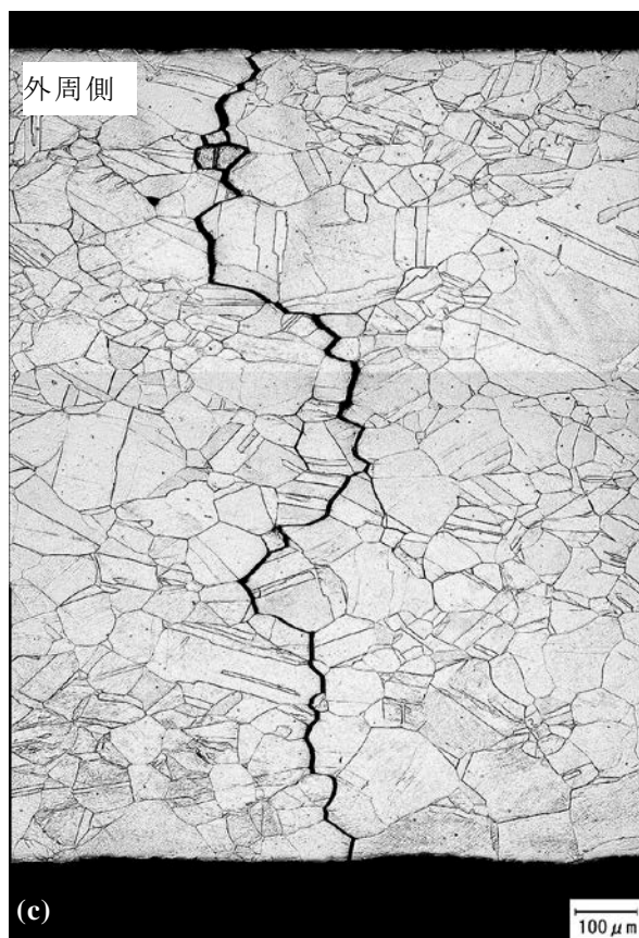
図 2-5 PWSCC 試験後断面光学顕微鏡写真 (600 合金, 20%冷間加工材, リバース U ベンド試験(360℃, PWR1 次模擬水, 1500h), 700℃×(a) 0 h, (b) 0.1 h, (c) 0.3 h, (d) 1 h)
