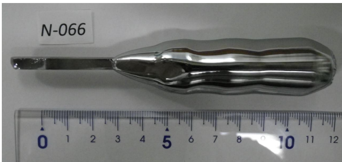
図 17. (a) CZ 法によって成長したゲルマニウム結晶。
