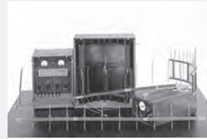
八木・宇田アンテナを初めて実用化した 極超短波無線送受信機
