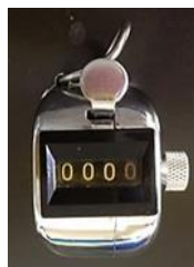
Fig. 22 : 細胞総数測定に用いた数取り器。血球計算盤を用いて細胞数を目視でカウントすることで総細胞数を見積もった。
