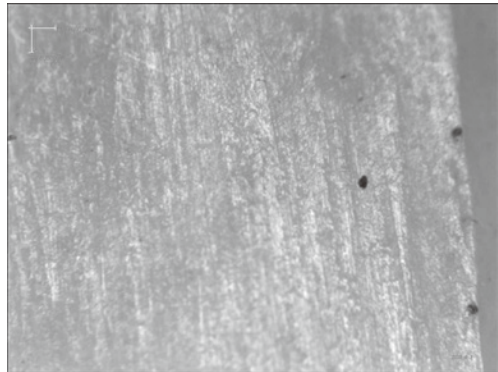
2 鉄ヤスリ、乾燥、1分・150回 (100倍) 2 iron, dry, 1 minute, 150 st.
