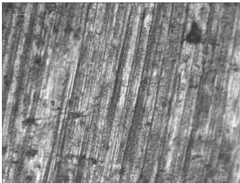
3 鉄ヤスリ、乾燥、1分・200回（100倍） 3 iron, dry, 1 minute, 200 st.
