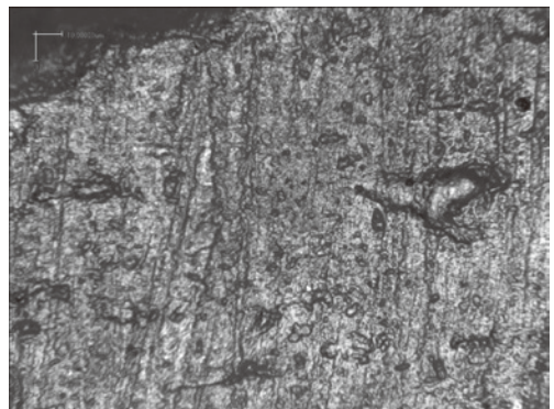
6 鉄ヤスリ、潤滑、1分・200回（100倍） 6 iron, wet, 1 minute, 200 st.
