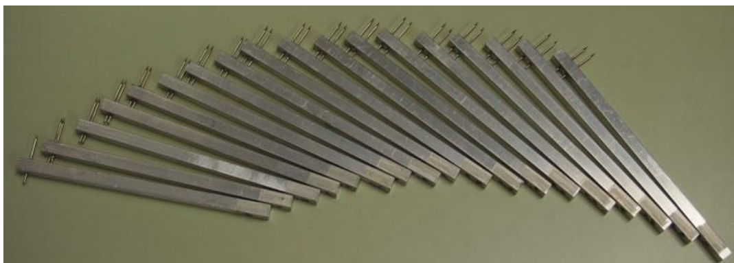
図 2 2点識別試験に用いた刺激装置
