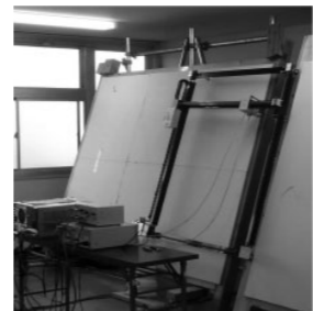
地表設置型合成開口レーダ(GB-SAR)システム。壁に設置し、走査することで破損箇所を特定できる。
