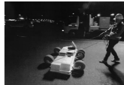
アレイ型地中レーダ(GPR)“やくも”。空港の舗装体内部の劣化箇所などを特定できる。
