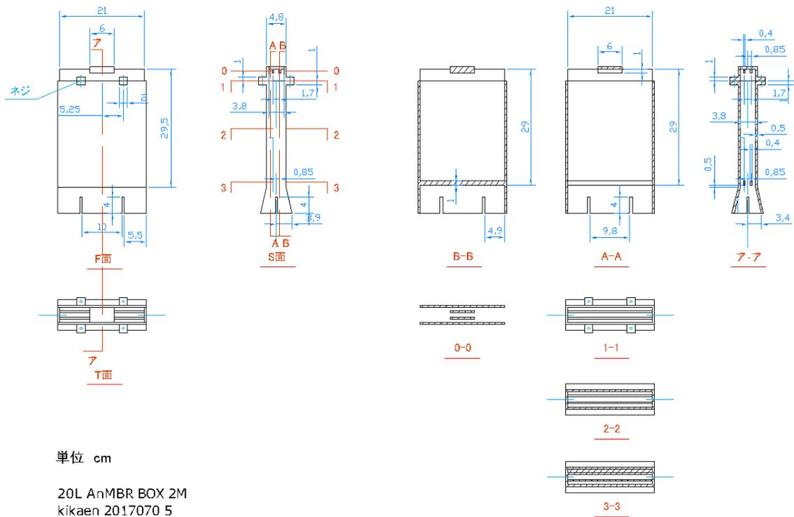
**Fig. A.3 BOX of the membrane module.**
