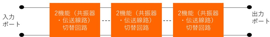
図 4.4 2 機能切替回路を用いた BPF 構成
