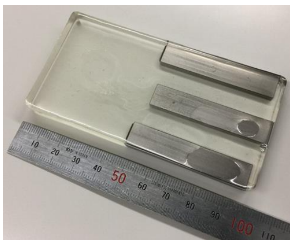
図 4.19 樹脂に包埋された棒型試験片
