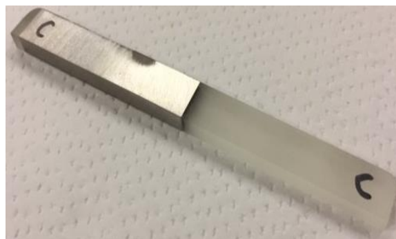
図 4.20 削り出された引張試験片
