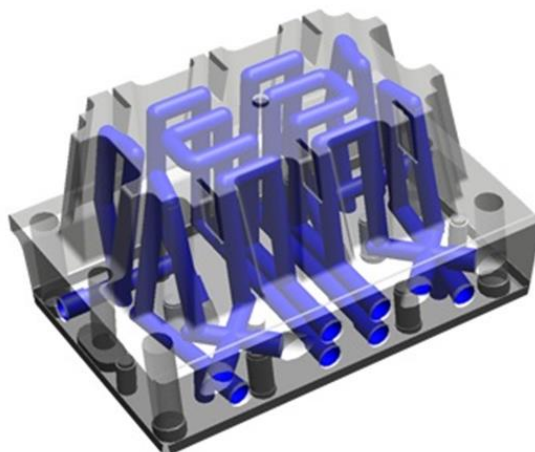
図 1.17 金属積層造形による、内部に水冷配管をもった射出成型金型 1-67)
