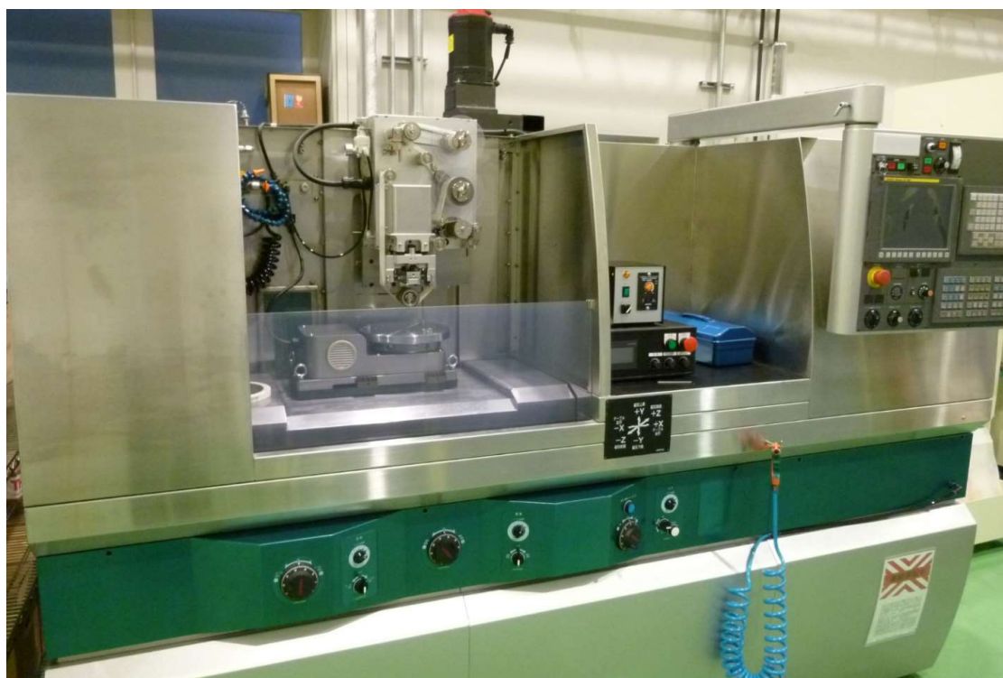
図 6.3 ウェハ対応テープ研削装置概観
