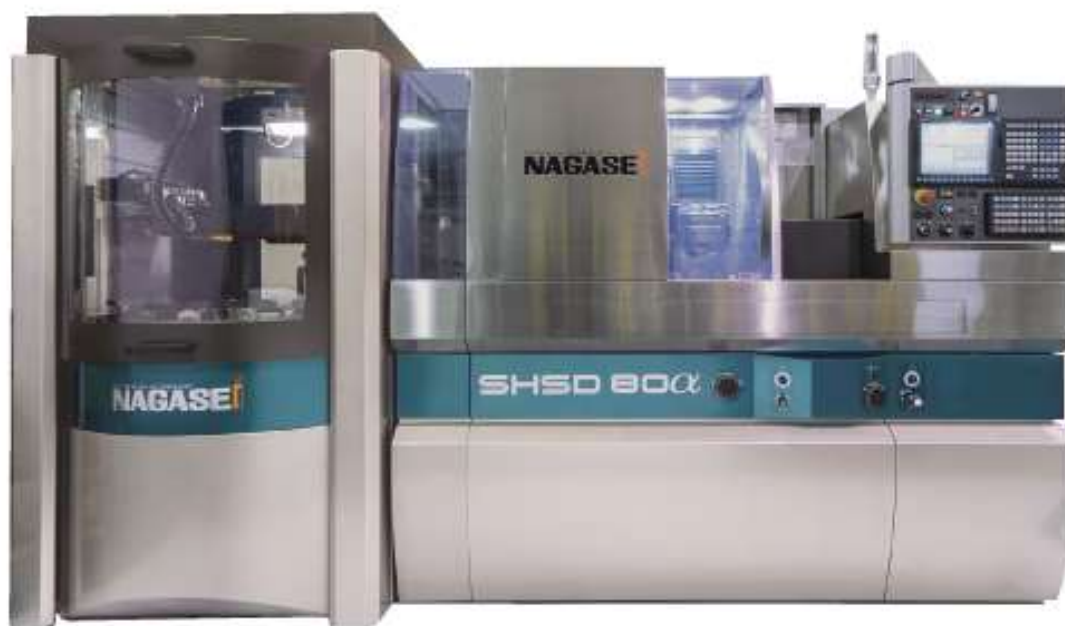
図 4.3 平面研削盤概観（ナガセインテグレックス製 SHSD 80 α）
