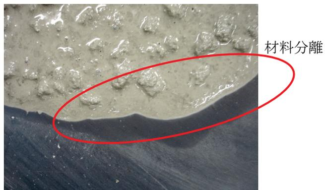
写真 4-3 スランプフロー試験時の性状 (LP:215 kg/m<sup>3</sup>、フロー:800 mm)
