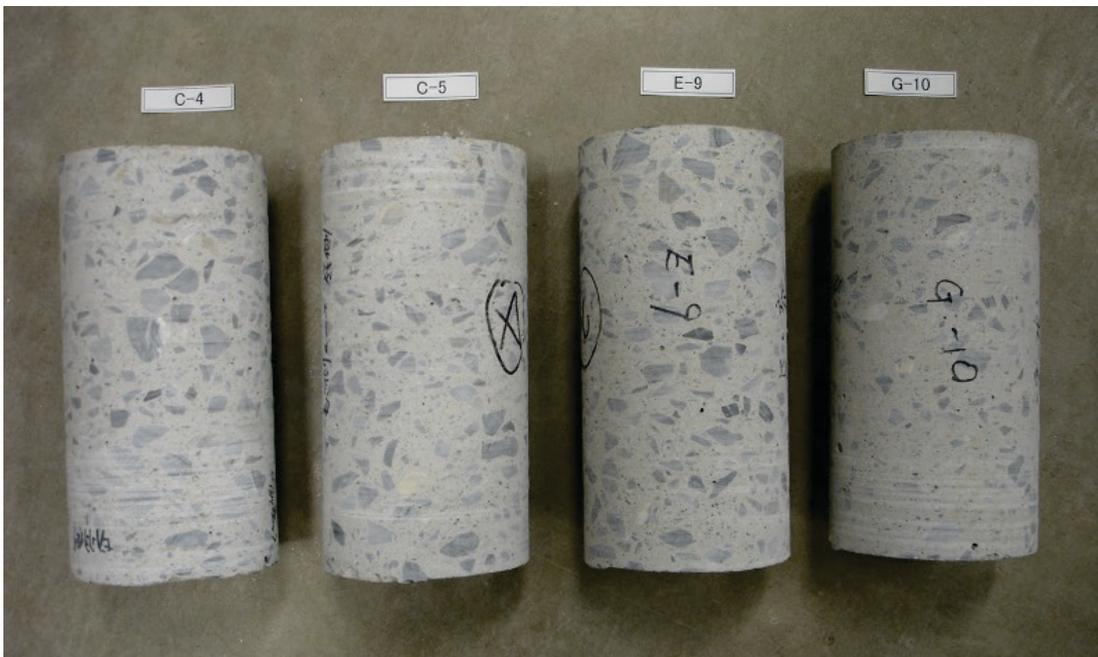
写真 6-21 コアの写真 (ポンプ方式)
