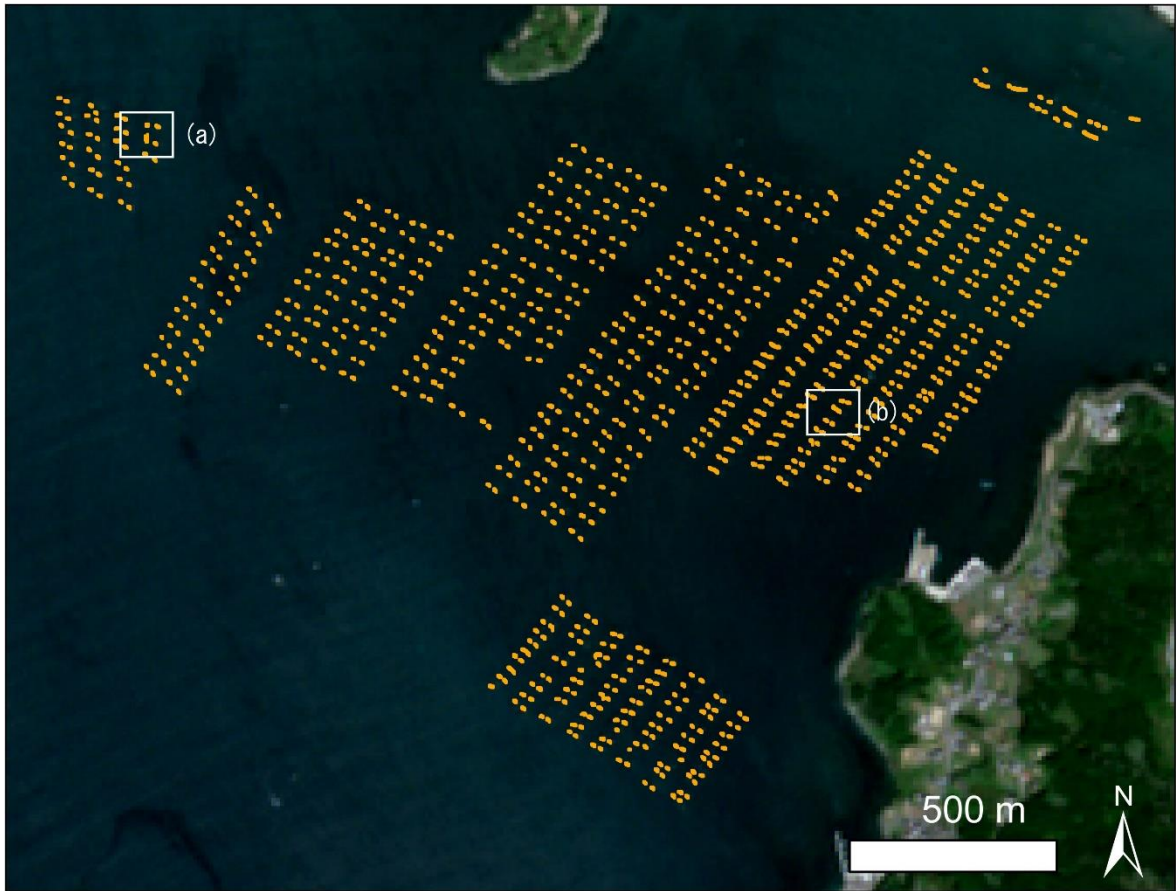
図 4.10 広田湾の 2015 年 4 月 30 日海面養殖施設マッピング結果（橙色：筏式養殖施設）。 背景は 2019 年 5 月の人工衛星 Sentinel-2A の画像を使用。
