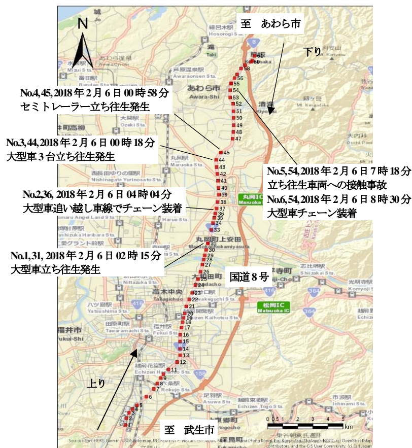
図 5-15 検証対象範囲(福井県国道 8 号)
