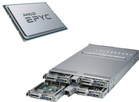
図3 サブシステム AOBA-B(プロセッサと4ノードシャーシ)
