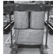
図1 カットコアと積層コアからなる直交磁心型可変インダクタの検証器の外観
