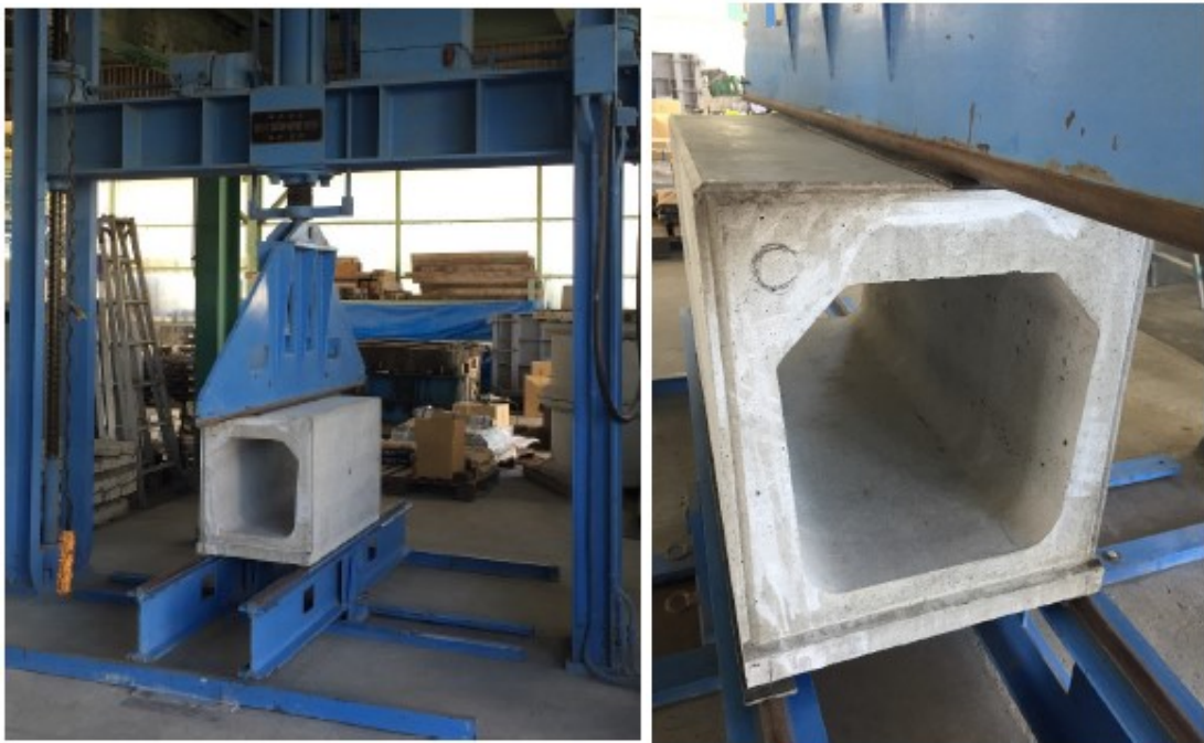
図-7.11 ボックスカルバートの載荷試験状況
