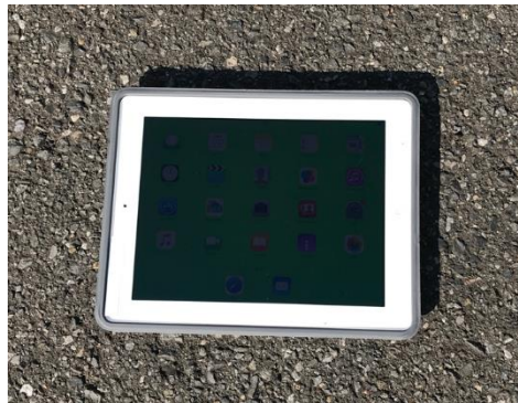
図 1.6 タブレット端末(透過型液晶ディスプレイ)を晴れた日に屋外で視認した際の見え方
