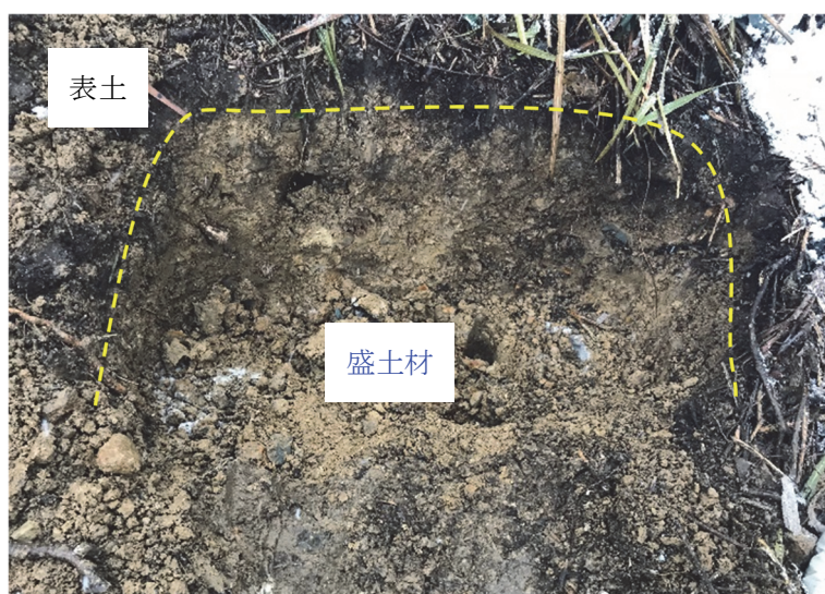
写真 4-2 盛土材試料採取状況
