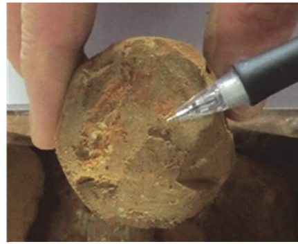
GL-10.90m 付近：風化シルト岩 粘土化・軟質化が顕著
