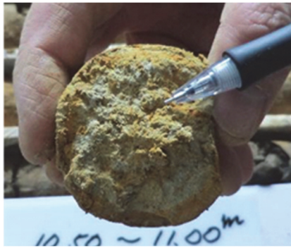
GL-10.65m 付近：風化シルト岩 岩組織を残す
