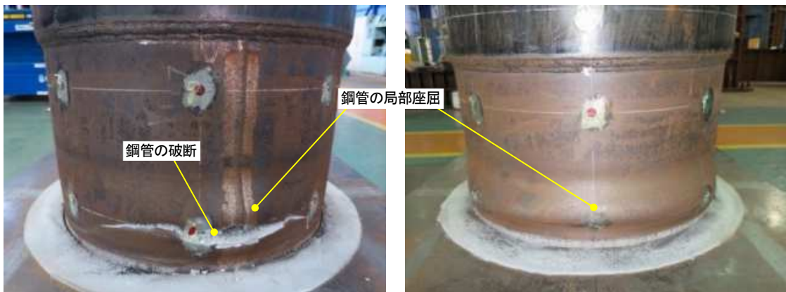
写真 4.13 実験終了後の状況 (Case BB2)
