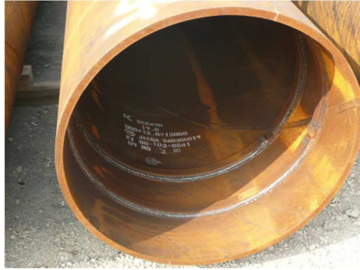
写真 1.5 鋼管内面のずれ止め
