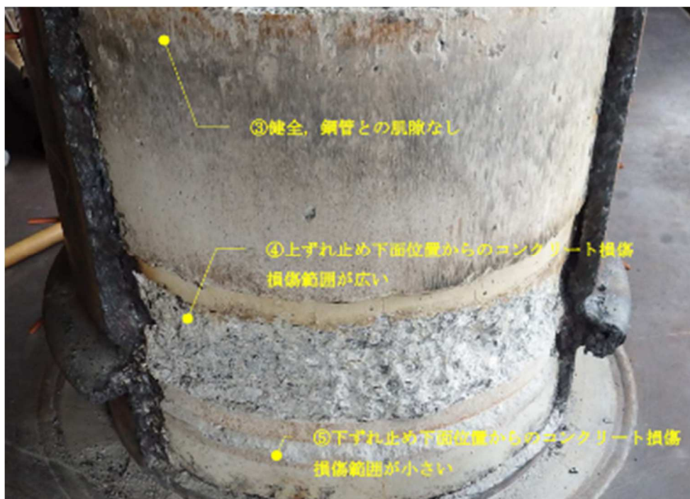
写真 4.9 試験後の管内充填コンクリートの状況 (Case BA3)
