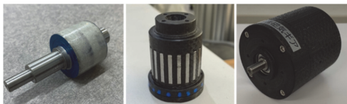
(a) インナーロータ (b) ポールピース (c) 磁気ギヤ
