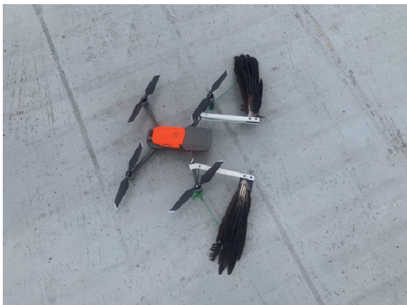
図. カラスの羽根を搭載した回転翼機
