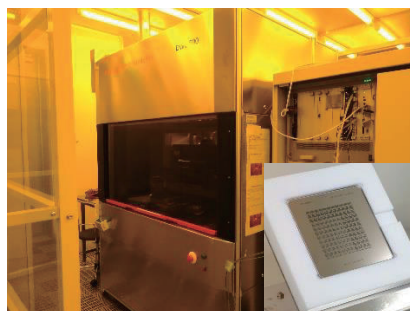
図5 フォトマスク作製装置
