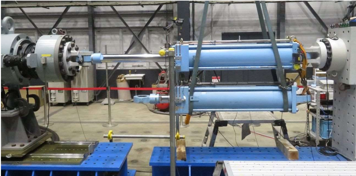
写真 3.3 限界減衰力の試験状況 (最伸び、1G 負荷)
