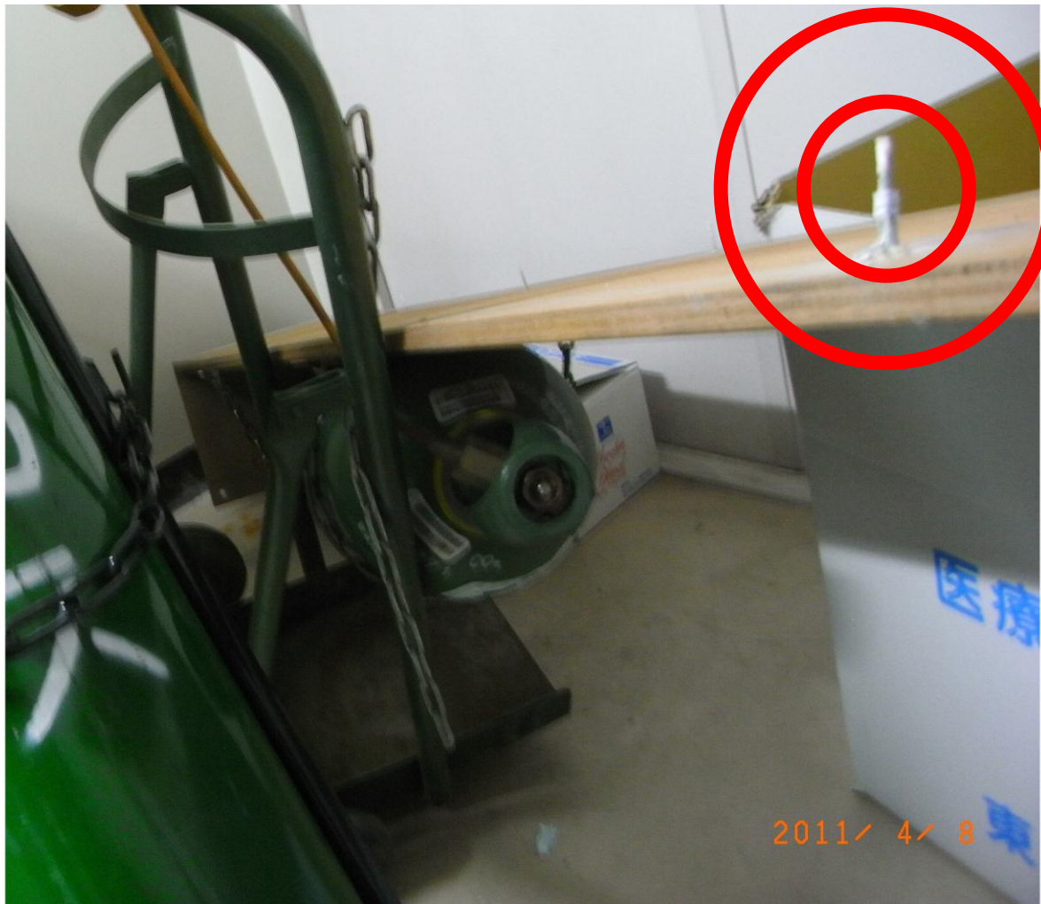
4月7日深夜の極めて強い余震のために、壁に固定していたはずの倒れたガスポンペ。隣の冷凍庫（-80℃）を破損。
