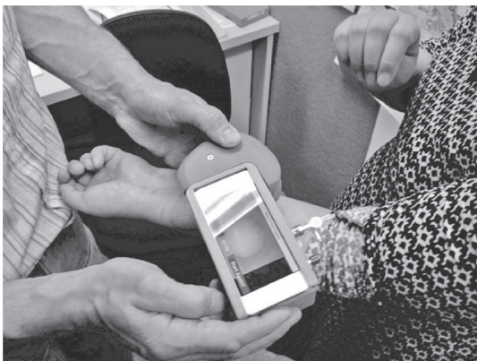
写真2. Biomedical Engineering 部門で開発中の血管脆弱性を評価する測定機器
