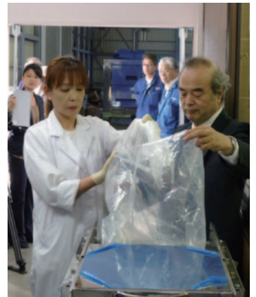
従来、放射性物質の測定にあたっては、検体(水産物、野菜、肉)を細かく切り刻む必要があったが、生活環境早期復旧技術研究センターが開発した新機器は、検体を解体せずにまるごと測定できるため、所要時間が大幅に短縮される。右が石井教授。なお同教授の取り組みは、東北大学災害復興新生研究機構の「06放射性物質汚染対策プロジェクト」に位置付けられている。
