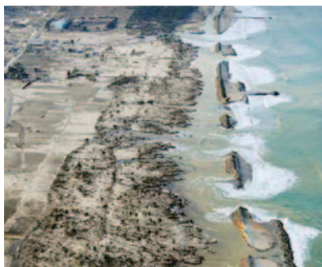
左は震災前の山元海岸(撮影:国土交通省東北地方整備局)、右は震災後(撮影:共同通信社、2011年3月19日)。仙台湾の中で最も大規模に被災した宮城県山元町の海岸。津波後は海岸背後が大きく浸食し、海岸堤防が方々で寸断している。
