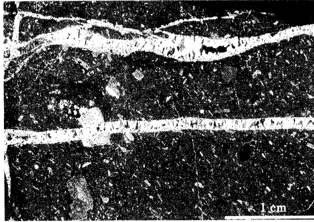
第5図 安山岩中に網目状に発達する含金石英脈 (中国吉林省八道鉱山)
