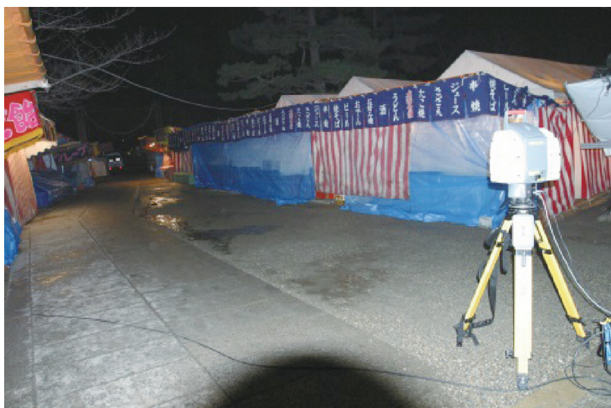
写真4 スキャナでのデータ取得風景
