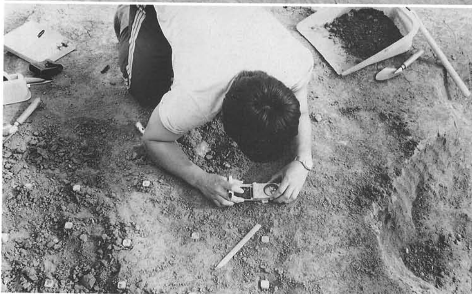
2. AOB 130-40 5層上面熱残留磁気測定用 サンプル偏角・伏角測定
