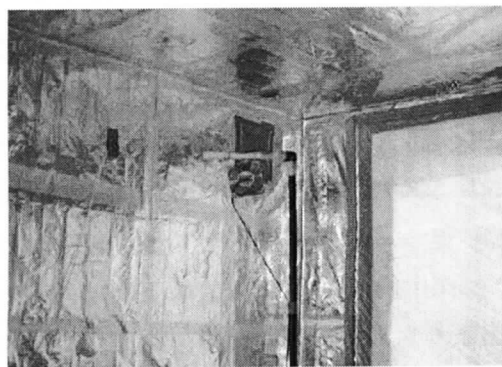
写真3-8-78 小型ファンのガス注入点
