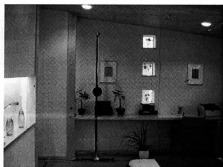
写真 3-8-49 上下温度とグローブ温度の測定の様子（寝室）
