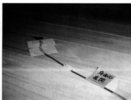
写真 3-8-50 床面の表面温度（居間）
