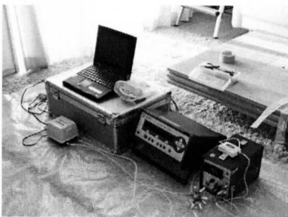
写真 2.4.11 換気量・侵入率 \kappa の測定
