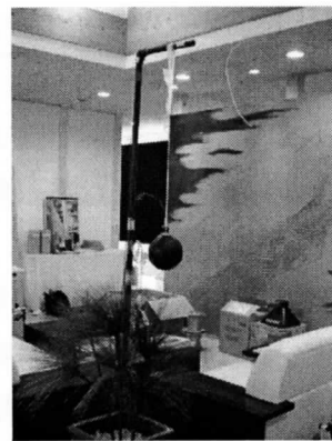
写真 3-8-48 上下温度とグローブ温度の測定の様子(居間)
