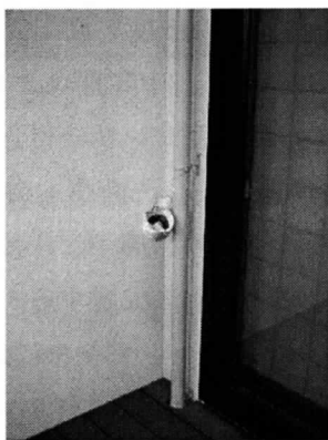
写真 3-8-47 温湿度センサー付き小型データロガー (外気・ウッドデッキ)
