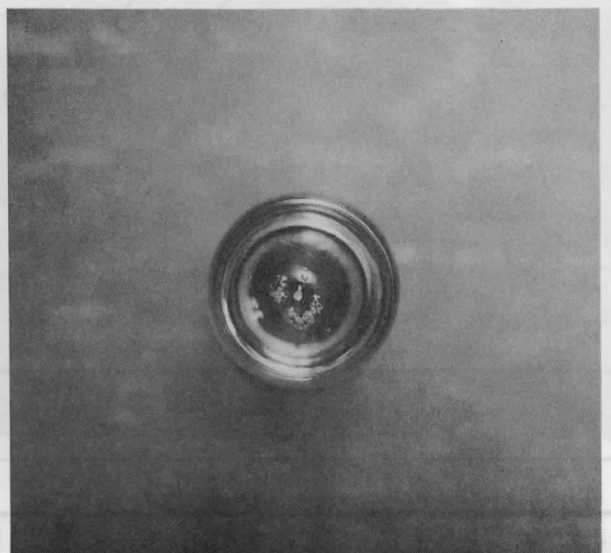
写真-4 熱湯に入れた場合の樹脂の溶解性状
