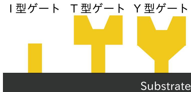
図 1.9: I 型・T 型・Y 型ゲート電極構造の断面模式図.
