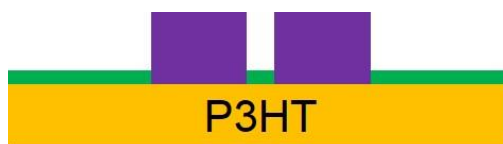
(d) Al蒸着膜のエッチング(除去)
