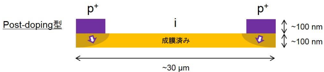
図 4.16 Post-doping 型の p^+ - i - p^+ 型トランジスタの構造模式図
