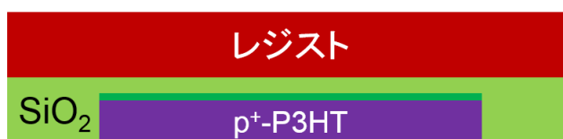
(a) \text{SiO}_2 層・レジストの成膜
