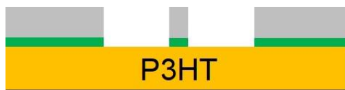
(b) SiO 2 ・Al蒸着膜のエッチング
