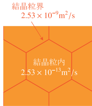
図- 2.27 結晶粒内および粒界における拡散係数
