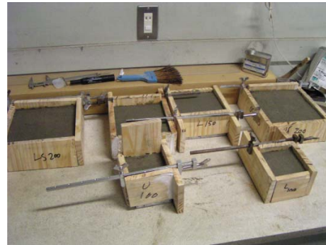
(b) Pouring the mortar
