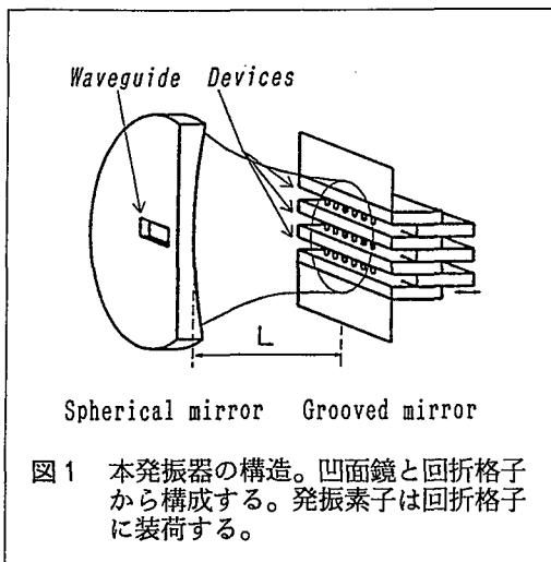
図1 本発振器の構造。凹面鏡と回折格子から構成する。発振素子は回折格子に装荷する。
