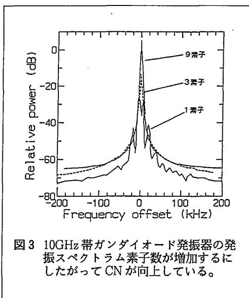
図3 10GHz帯ガンダイオード発振器の発振スペクトラム素子数が増加するにしたがってCNが向上している。
