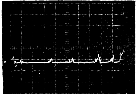
図 6.1 砥粒切れ刃による切削パルスの実測結果の一例
