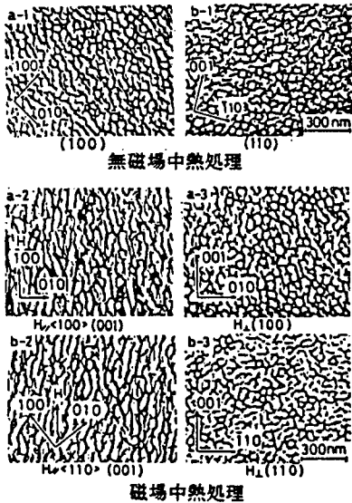
図2 Fe-22Cr-17Co \langle 100 \rangle , \langle 110 \rangle 単結晶に対して、695℃、12minの磁場中および無磁場中熱処理を行った最終硬質化後の2相分離組織
